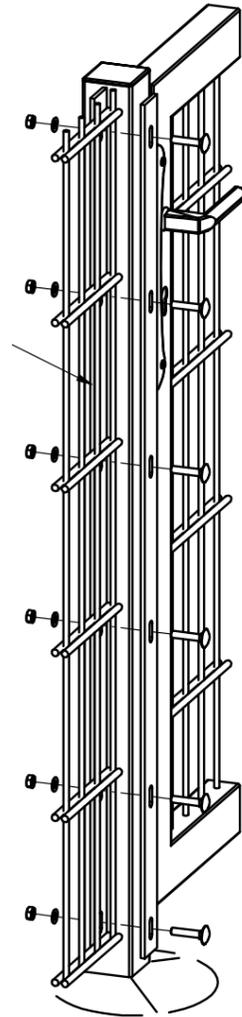
Doppelstabgittermatte in der Höhe entsprechend zur Torhöhe mittels Schlossschrauben M8x40 und der Abdeckleiste am Pfosten anschrauben.
